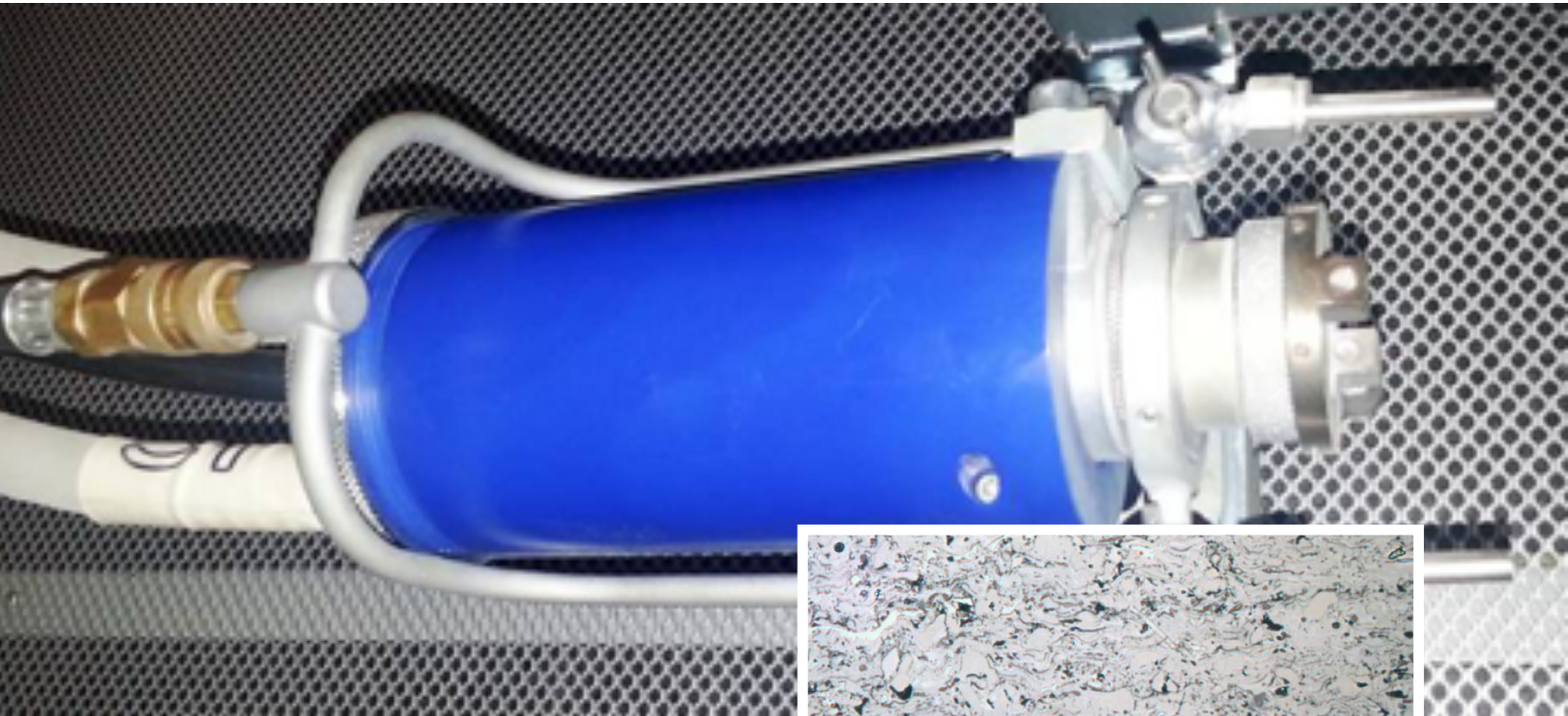
Şekil 8 F4-MB Plazma Sprey Tabancası (Sulzer)
